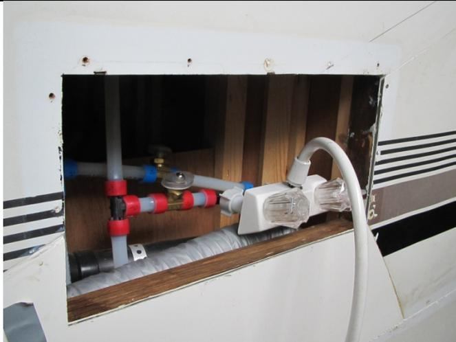
Einbau der Außendusche mit Dekalin Kleber
