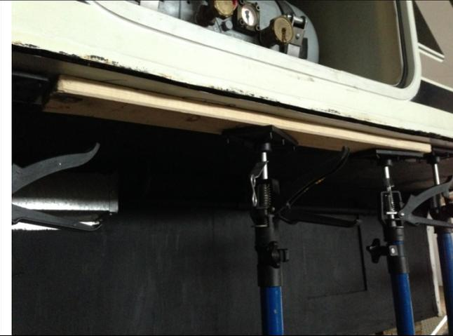
Geschädigten Holzboden mit Bitumen versiegelt und Blech zur Stabilisierung aufgeklebt
